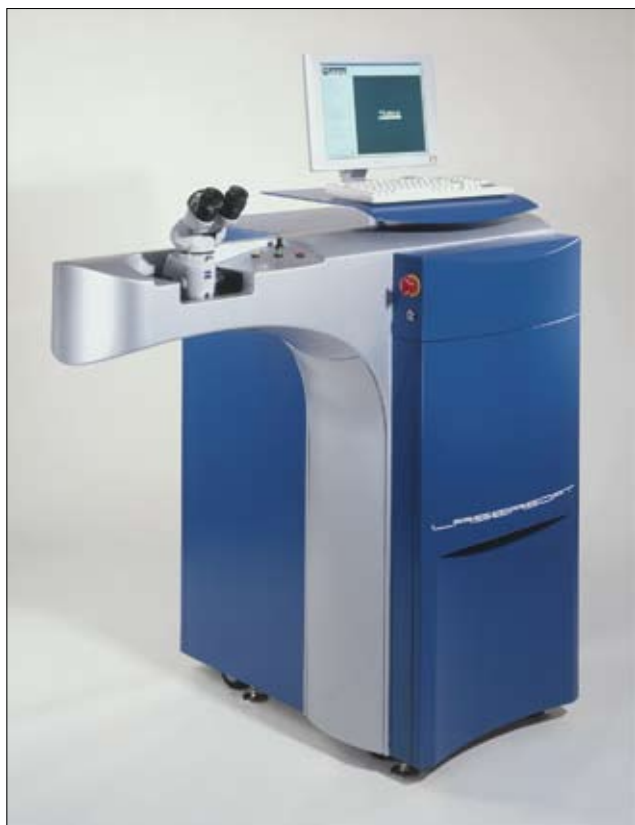
■ RYCINA 9.1 Laser stałokrystaliczny LaserSoft (dzięki uprzejmości firmy Katana).
